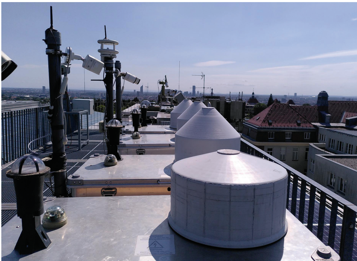
Abbildung 3: Die vier EM27-SUN Spektrometer der TUM, die in Wien im Einsatz waren, nach der Kampagne auf dem Dach des Schwackhöfer-Hauses, BOKU. Das Institut für Meteorologie stellte die Messplattform zur Verfügung.
